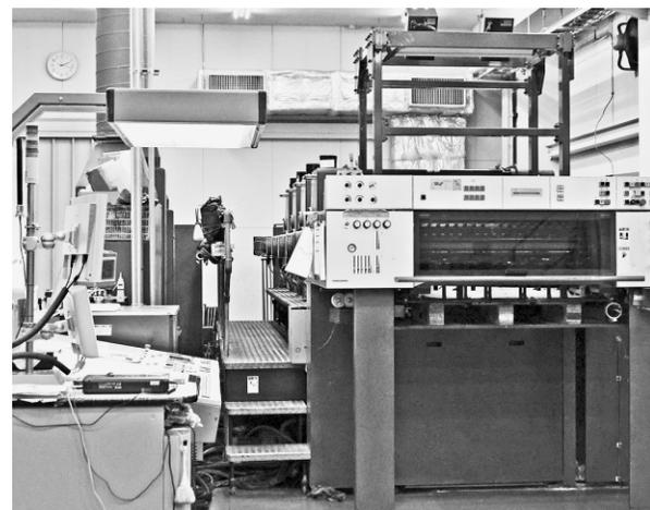
インライン紙面検査装置を搭載した菊全4色機
