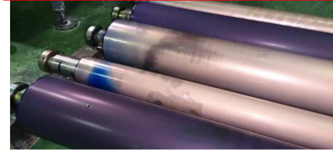
ローラに蓄積した炭酸カルシウム
