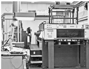
ンライン紙面検査装置を搭載した菊全 4 色機
