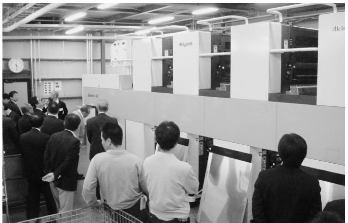
パウダーレス仕様で運用する水なし両面8色機
