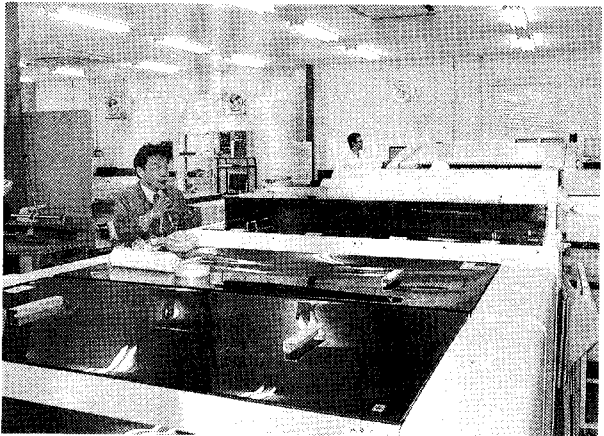
水なし専用として使用される富士フィルム Luxel T-9800のライン
